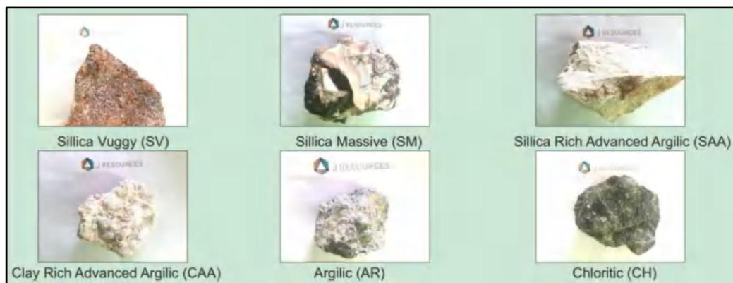
Gambar 3 Tipe alterasi Batuan (PT. JRBM, 2020)
