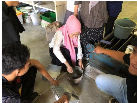
Mengukur Slump flow dari campuran yang telah dibuat.
