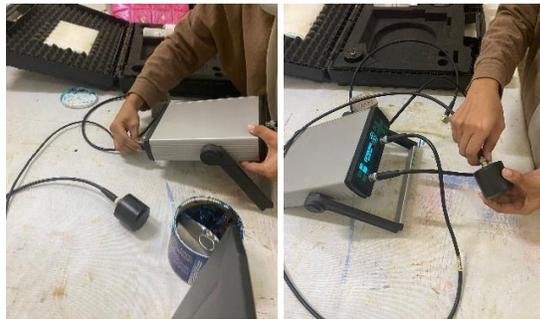
Langkah kedua yaitu mengoles gemuk (gel stempet) pada ujung sampel yang akan diletakkan transduser, dan mulai pembacaan kecepatan rambat gelombang pada alat, serta mencatat hasil kecepatan rambat gelombang dari alat.
