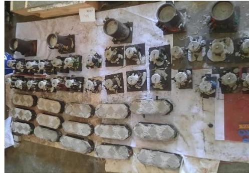
Pemberian label nama varian di setiap mortar sebelum dilakukan pembongkaran bekisting/ cetakan.
