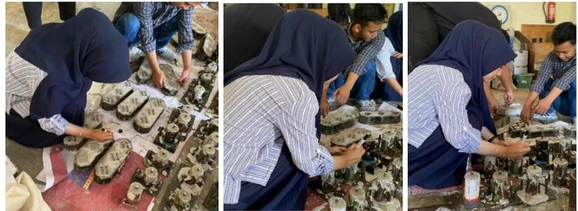
Setelah diberikan label nama sesuai varian, selanjutnya membuka atau membongkar bekisting/ cetakan mortar, kemudian hasil mortar dikeluarkan dari cetakan. Campuran mortar yang telah dikeluarkan, kemudian dilanjutkan dengan membersihkan bekisting/ cetakan mortar dan direkatkan kembali seperti semula.
