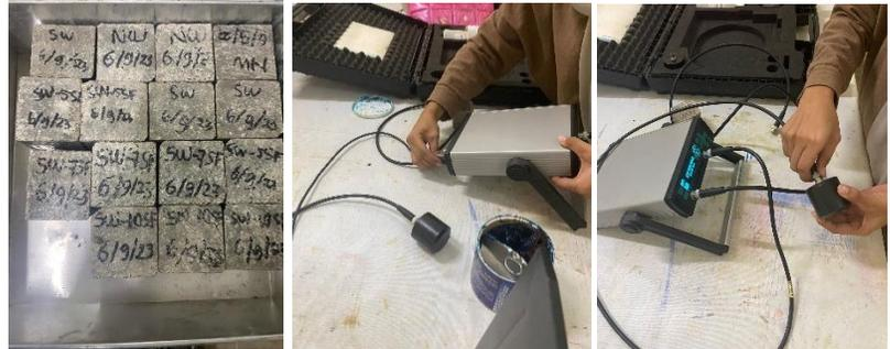
Langkah kedua yaitu mengoles gemuk (gel stempet) pada ujung sampel yang akan diletakkan transduser, dan mulai pembacaan kecepatan rambat gelombang pada alat, serta mencatat hasil kecepatan rambat gelombang dari alat.
