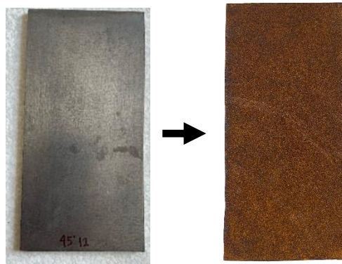
Gambar 4. Perubahan permukaan logam yang ditandai dengan munculnya karat
