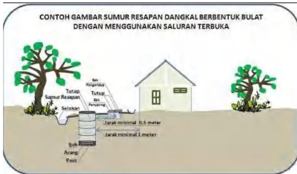
Gambar 2 Sumur Resapan
