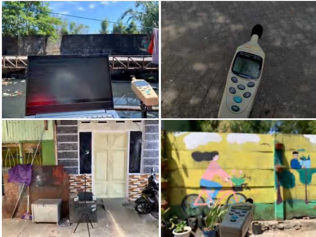
Pengukuran menggunakan alat Sound Level Meter pada tiap titik pengamatan yang dihubungkan dengan software SLM Rev-01
