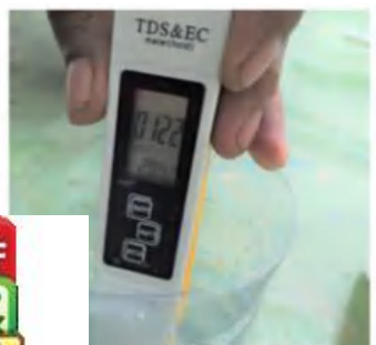
(Hasil pengukuran TDS, pH, dan salinitas permeat pada pengulangan ke-3)
