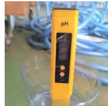
(Hasil pengukuran TDS, pH, dan salinitas permeat pada pengulangan ke-3)
