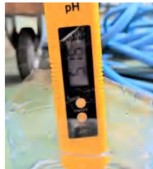
(Hasil pengukuran TDS, pH, dan salinitas permeat pada pengulangan ke-2)
