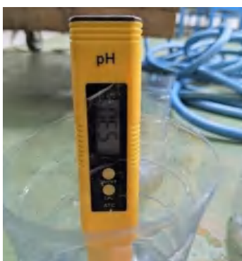
(Hasil pengukuran TDS, pH, dan salinitas permeat pada pengulangan ke-3)
