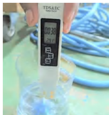
(Hasil pengukuran TDS, pH, dan salinitas permeat pada pengulangan ke-2)
