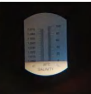
(Hasil pengukuran TDS, pH, dan salinitas permeat pada pengulangan ke-3)
