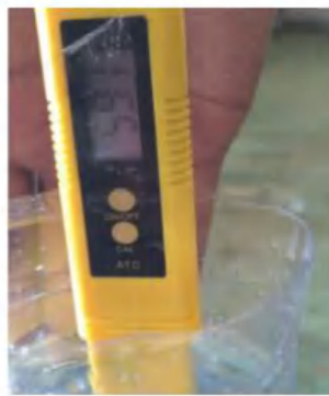
(Hasil pengukuran TDS, pH, dan salinitas permeat pada pengulangan ke-1)
