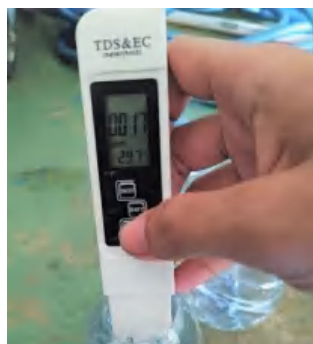
(Hasil pengukuran TDS, pH, dan salinitas permeat pada pengulangan ke-2)
