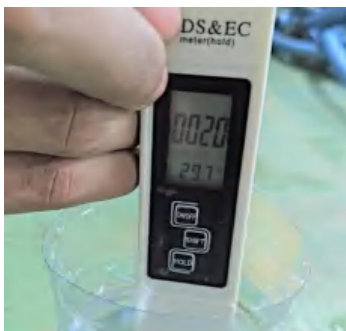
(Hasil pengukuran TDS, pH, dan salinitas permeat pada pengulangan ke-2)
