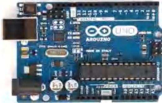
Gambar 7. Mikrokontroler Arduino Uno
