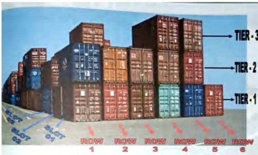
Gambar 2. Sistem Penumpukan *Blok, Row, Slot* dan *Tier* (PT. TPM,2023)
