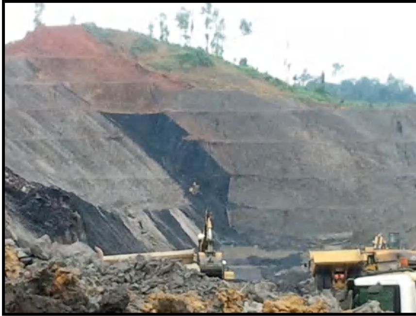
Gambar 12 Penampakan klinker pada singkapan seam T daerah tambang Sambarata memotong lapisan batubara secara horizontal (Asmoro dkk, 2022)
