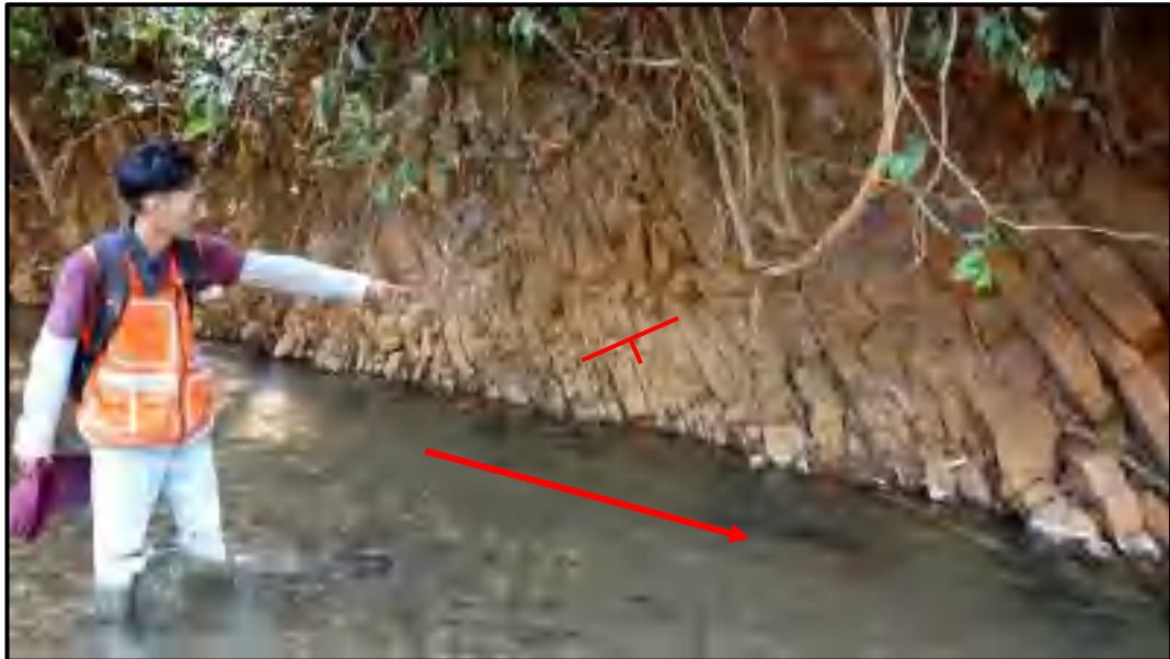
Gambar 30 Kenampakan tipe genetik konsekuen pada sungai La Molowu dengan kedudukan batuan batugamping N 290°E/32° Difoto ke arah N 109° E pada stasiun 46
