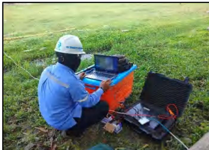
**Gambar 4** Pengukuran Geolistrik
