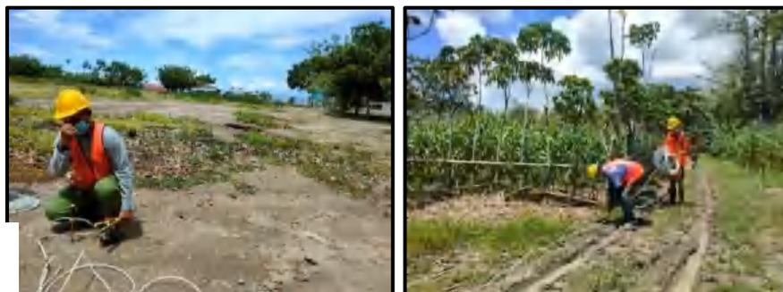
**Gambar 5** Pemasangan Elektroda
