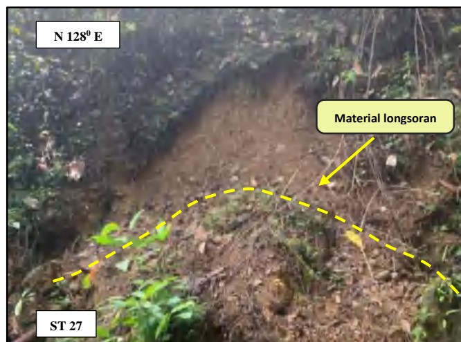
Gambar 2.7 Kenampakan material debris slide pada litologi basal di Kecamatan Bua bagian timur pada stasiun 27 dengan arah foto N 128° E
