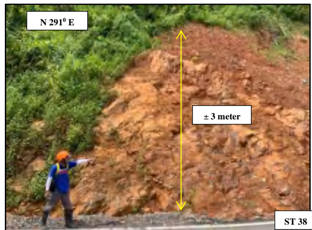
Gambar 2.12 Residual soil hasil pelapukan filit dengan warna soil merah kecoklatan sampai kehitaman dengan ketebalan \pm 3 meter pada daerah tenggara Kecamatan Basse Sang Tempe pada stasiun 47 dengan arah foto N 291° E
