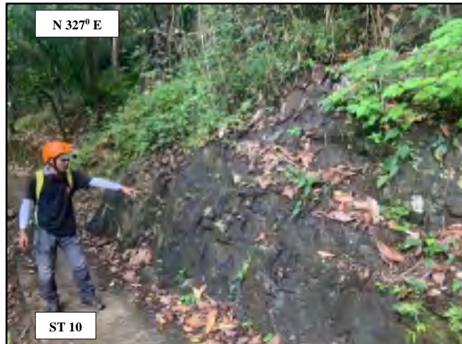
Gambar 2.2 Kenampakan litologi basal yang mengalami pengaruh pelapukan biologi pada stasiun 10 dengan arah foto N 327° E
