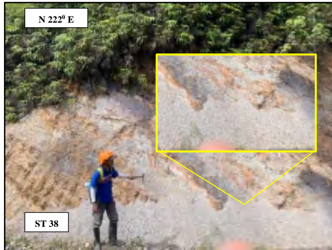
Gambar 2.11 Kenampakan pelapukan fisika pada litologi batupasir berupa thermal expansion dengan warna soil abu-abu kecoklatan pada daerah Bonglo stasiun 38 dengan arah foto N 222° E
