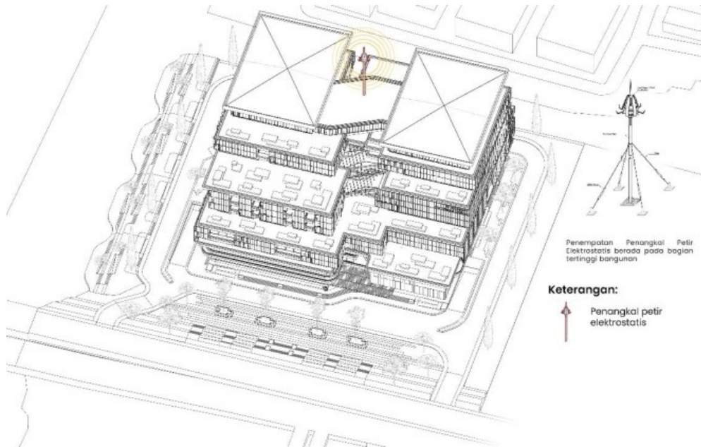
Gambar 19 Isometri Sistem Penangkal Petir
