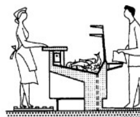
② Meja untuk ikan-ikan dengan pendingin dan tempat pembuangan cairan
