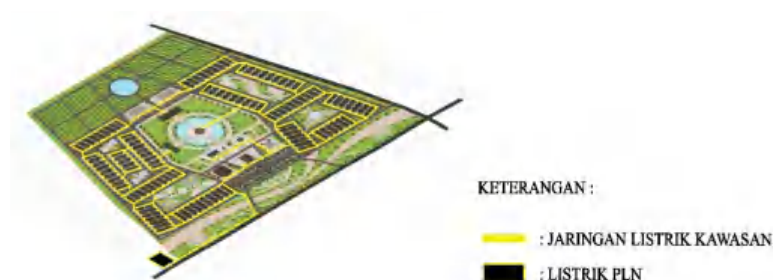
Gambar 17 Sistem Mekanikal Elektrikal
