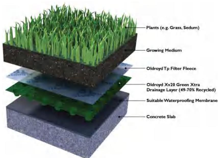
Gambar 23 Lapisan konstruksi green roof
