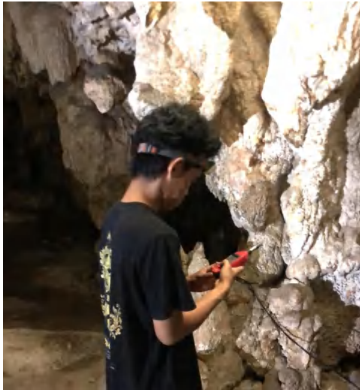
d. Pengukuran suhu dan kelembaban dengan Temperature/Humadity Meter
