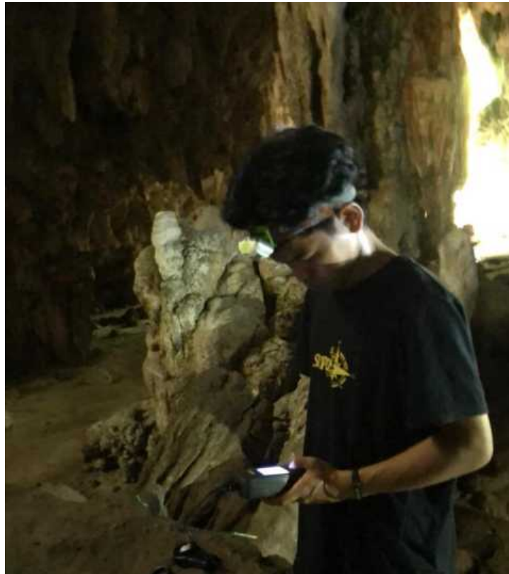
b. Pengukuran Intensitas cahaya menggunakan alat LED Light Meter
