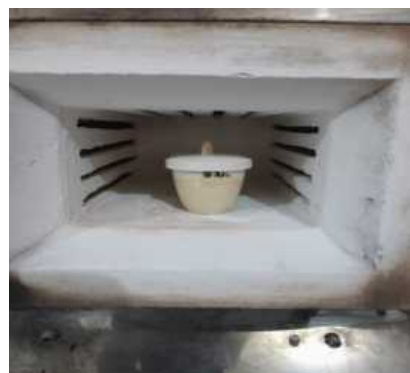
Kalsinasi tulang kerbau
