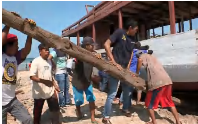
Gambar 2 Mengangkat lunas dan mendorong sisi kapal (Transmedia, 2019)
