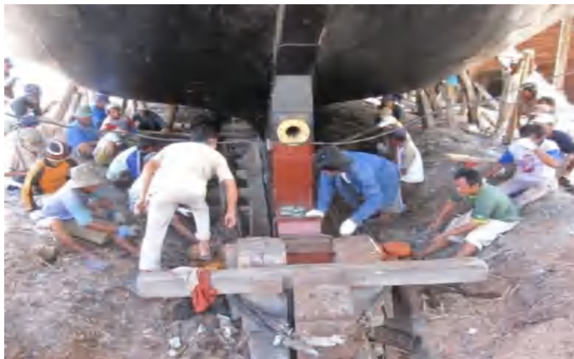
Gambar 5 Proses sistem peluncuran tradisional kapal berukuran besar (Noegraha, 2017)
