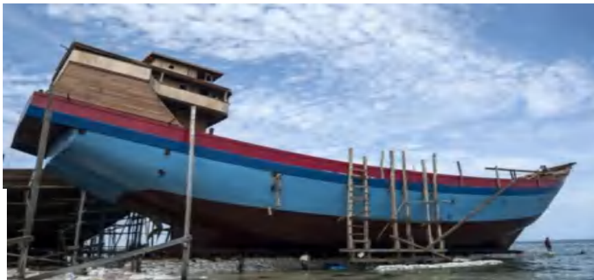
Gambar 4 Proses pengaturan landasan dan balok luncur (Transmedia, 2019)
