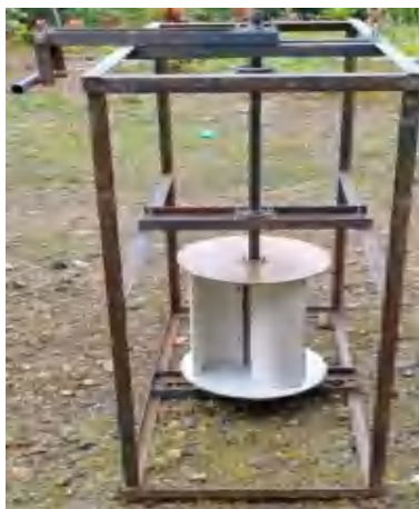
Gambar 5. Rangka Alat Uji dengan sudu tanpa alur
