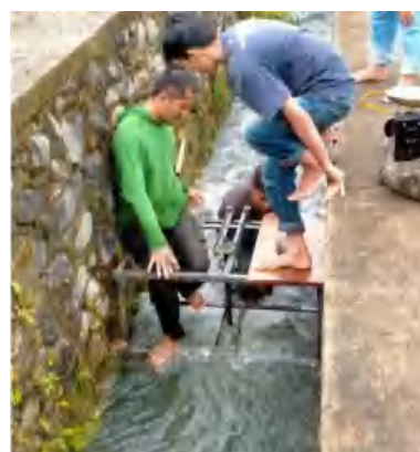
Gambar 1. Set up alat uji pada saluran irigasi
