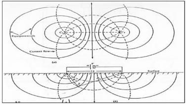
**Gambar II.5** Distorsi garis ekuipotensial dan garis aliran arus pada dua titik sumber arus (a) Denah; (b) Penampang vertikal dipermukaan tanah (Telford et al., 1990)
