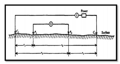
**Gambar II.4** Dua elektroda arus dan potensial di permukaan bumi yang homogen isotropis (Telford et al., 1990)
