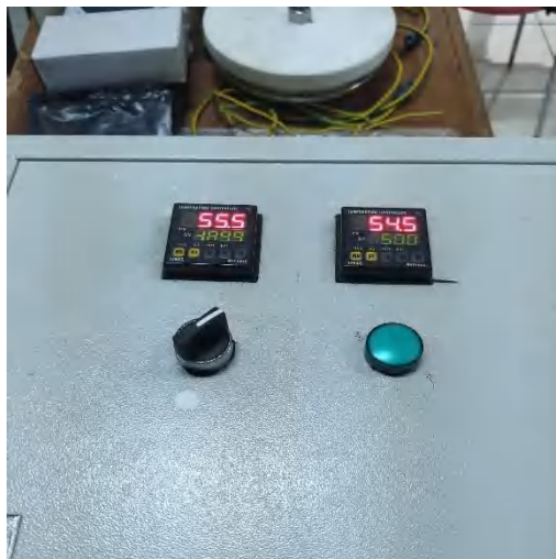
Lampiran 19. Suhu output 55 °C pada alat pengering.
