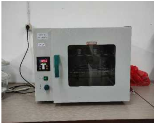
Lampiran 22. Pengovenan sampel pada suhu 105 °C.
