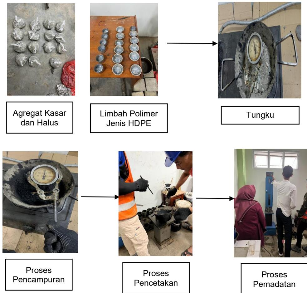
**Gambar 17.** Proses Pembuatan Briket Aspal
