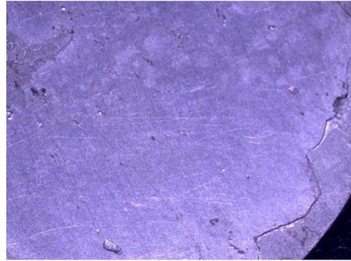
Spesimen Setelah Uji Korosi
