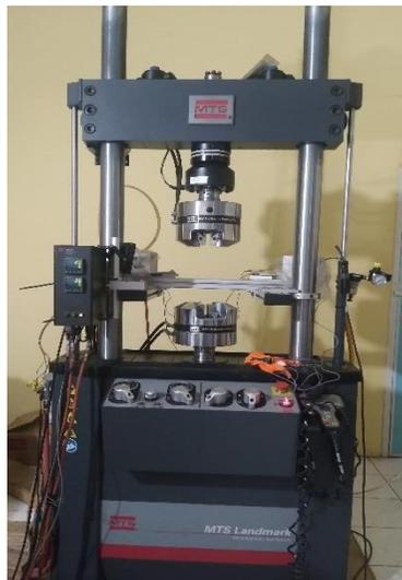
**Gambar 4.4** Alat uji perambatan retak fatik
