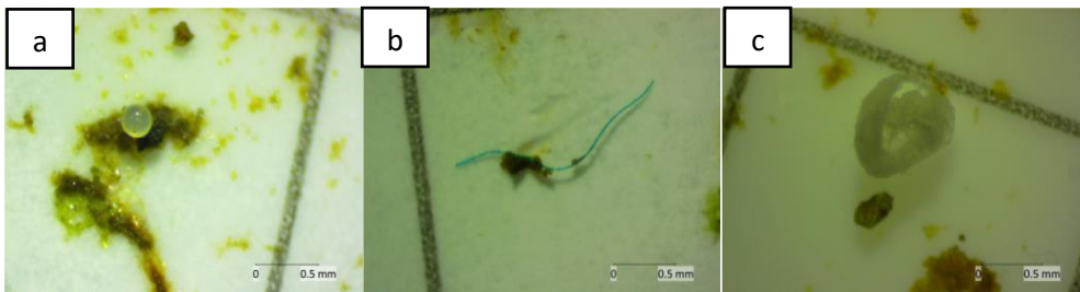
Gambar 1. Jenis mikroplastik berdasarkan sumbernya. a) granule (mikroplastik primer), b) fiber (mikroplastik sekunder) dan c) Fragmen (mikroplastik sekunder) (Kama et al., 2021)
