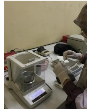
Gambar 7. Penimbangan sampel untuk tahap metilasi
