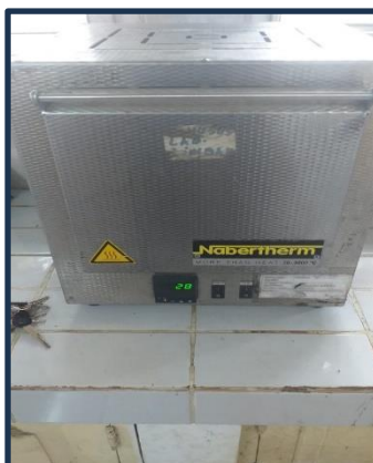
Sintering /Pemanasan sampel pada suhu (550°C, 600°C, 650°C, 700°C, 750°C, 800°C)
