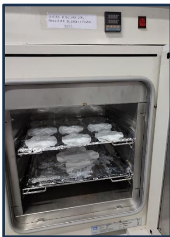
Pengeringan dengan oven selama 5 jam pada temperatur 95°C.
