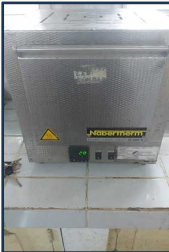
Kalsinasi : pemanasan dengan suhu 900°C dengan waktu 5 jam
