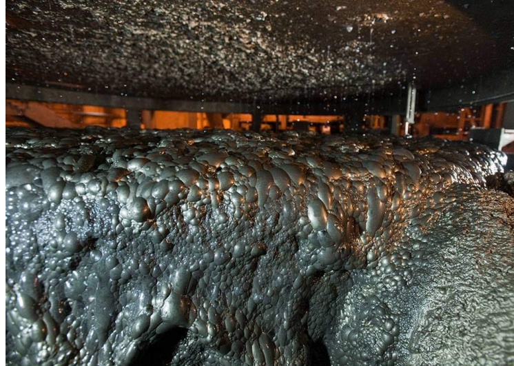
Gambar 8 Buih dengan kandungan mineral berharga
