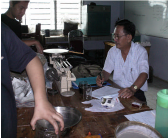
Gambar D7. Penimbangan Agregat
