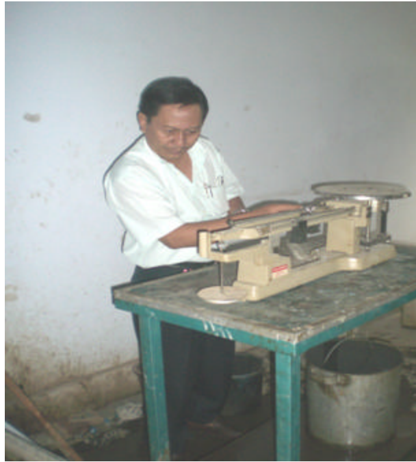
Gambar D15. Penimbangan Benda Uji Dalam Air
