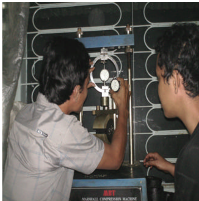
Gambar D16. Pengujian Marshall
