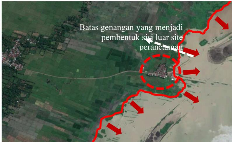
Gambar 45 Batas genangan dan daratan dalam kondisi normal yang menjadi salah satu faktor pemberi bentuk site perancangan
