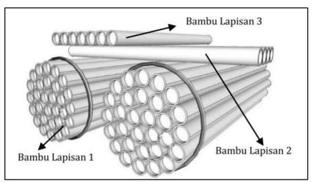
Gambar 3 Struktur penampang bambu pada rakit di rumah mengapung
