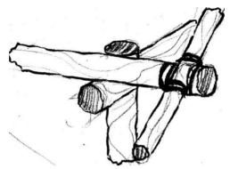
Gambar 22 Sistem struktur ikat konstruksi atap rumah Suku Bajo
