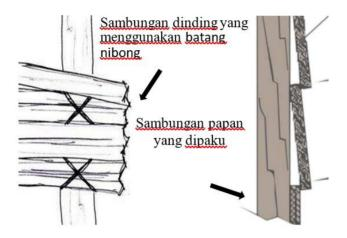
Gambar 20 Konstruksi dinding Suku Bajo
