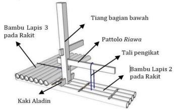
Gambar 6 Detail Struktur Tiang Bawah dengan Alas Kaki Tipe Aladin
