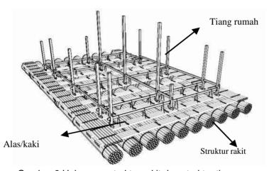
Gambar 9 Hubungan struktur rakit dan struktur tiang
