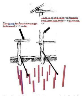
Gambar 18 Konstruksi tiang rumah Suku Bajo
