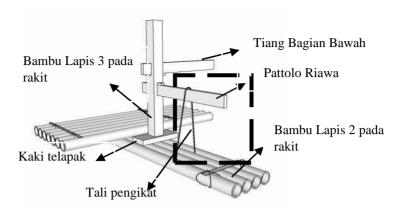
Gambar 8 Struktur dan detail tiang bawah dengan alas kaki tipe telapak
