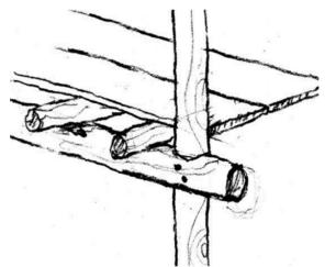
Gambar 19 Konstruksi lantai rumah Suku Bajo
