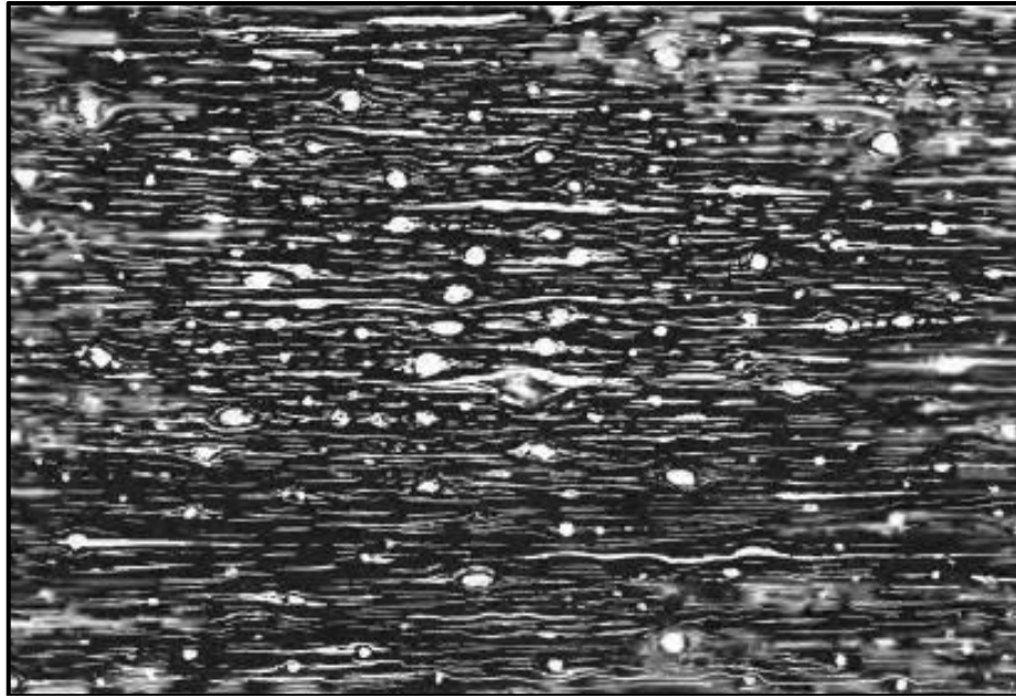
Gambar 8. Fotomikrografi ultramylonit dari batuan asal granit. Warna putih merepresentasikan porfiroklas atau jejak material porfiroklas, warna hitam adalah mineral berukuran halus (Higgins, 1971).
