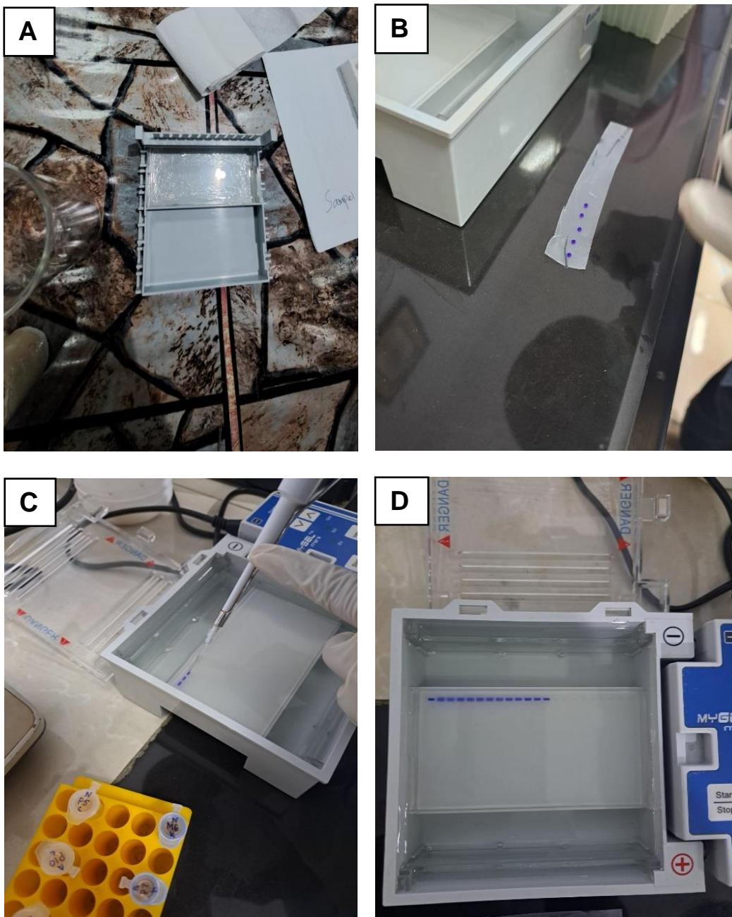
**Keterangan:** **A)** Penyiapan agar elektroforesis **B)** Pencampuran DNA sampel dengan pewarna DNA **C)** Pemindahan campuran DNA dan pewarna ke dalam sumur gel elektroforesis **D)** Campuran DNA yang siap dielektroforesis
