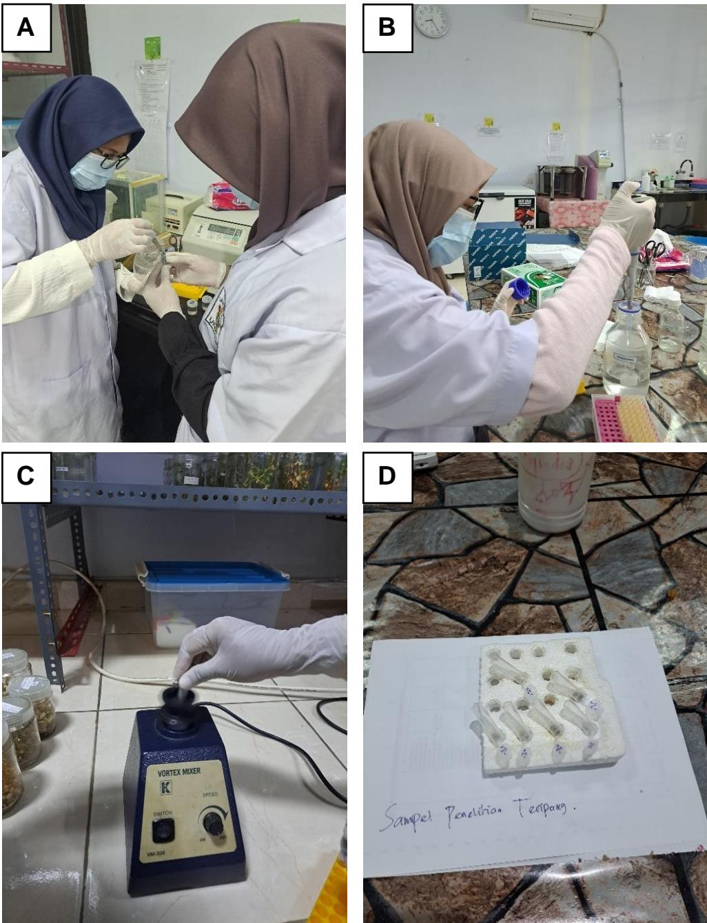
**Keterangan:** **A)** Penggerusan sampel teripang pasir **B)** Penambahan reagen isolasi DNA menggunakan metode kit ekstraksi **C)** Pencampuran reagen lisis menggunakan vorteks **D)** Tahap pengeringan sampel DNA metode CTAB
