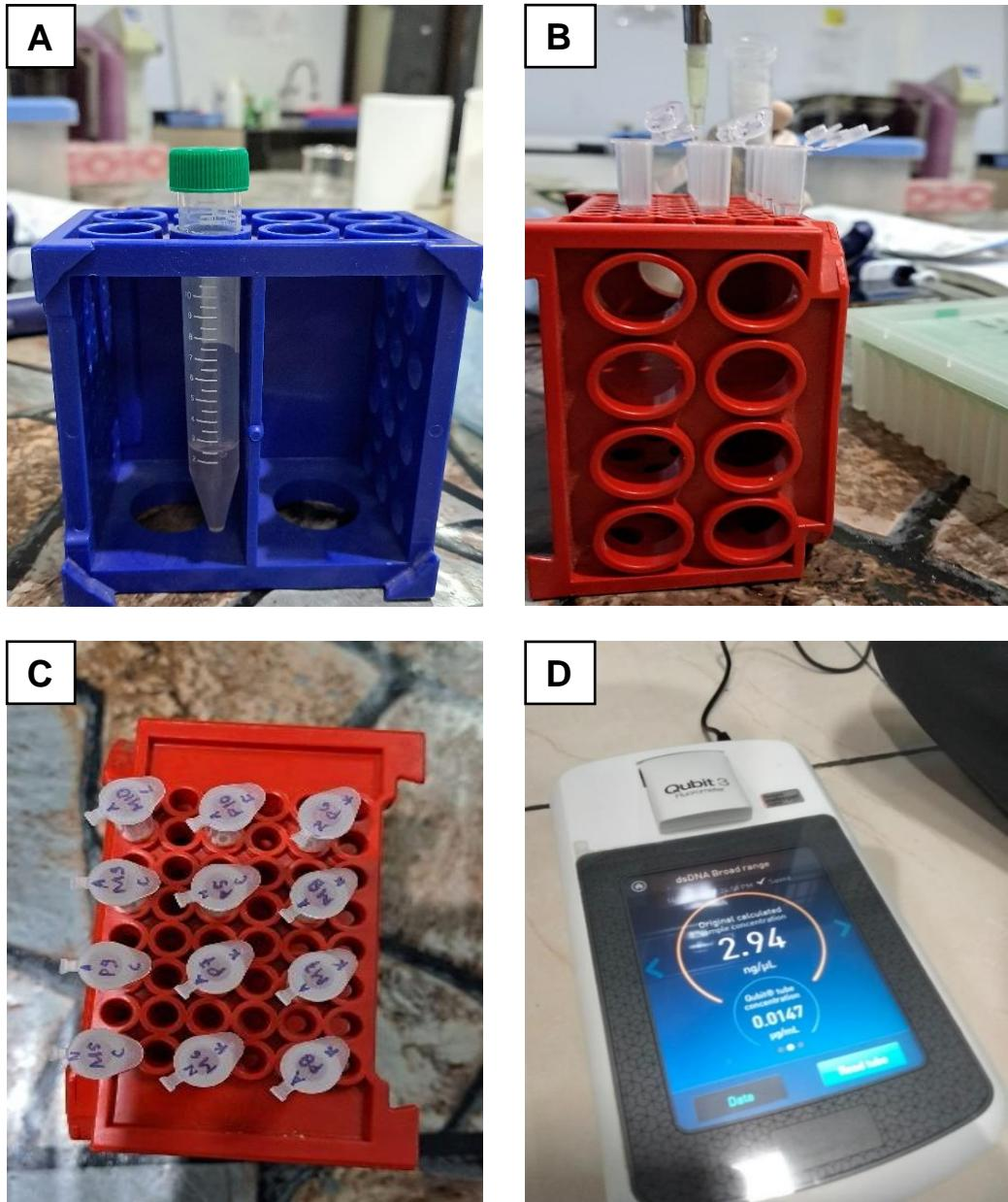
**Keterangan:** **A)** Penyiapan larutan Qubit buffer untuk pengukuran kuantitas DNA **B)** Pemindahan Qubit working solution ke dalam sampel **C)** Sampel yang telah ditambahkan Qubit working solution **D)** Pengukuran kuantitas DNA menggunakan Qubit Fluorometer
