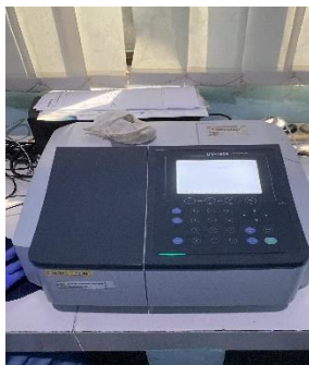
UV-1.800 alat yang digunakan dalam proses analisis kadar sisa klorin di kolam renang Universitas Hasanuddin dan kolam renang Tirta Lontara Makassar
