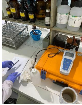
pH meter alat yang digunakan dalam proses analisis pH air kolam renang Universitas Hasanuddin dan kolam renang Tirta Lontara Makassar
