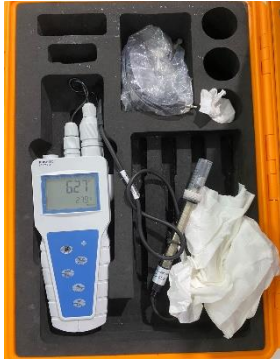
pH meter alat yang digunakan dalam proses analisis pH air kolam renang Universitas Hasanuddin dan kolam renang Tirta Lontara Makassar
