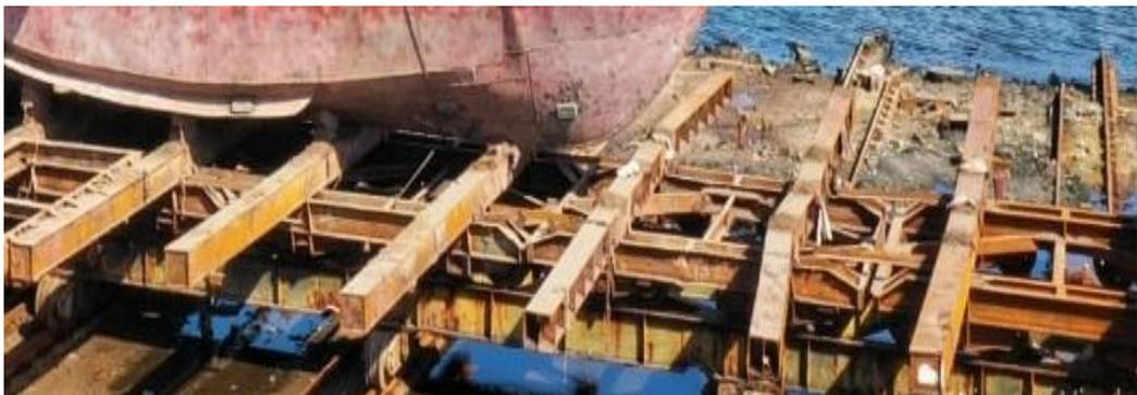
**Gambar 5.** Stopblok H-beam untuk menumpu kapal
