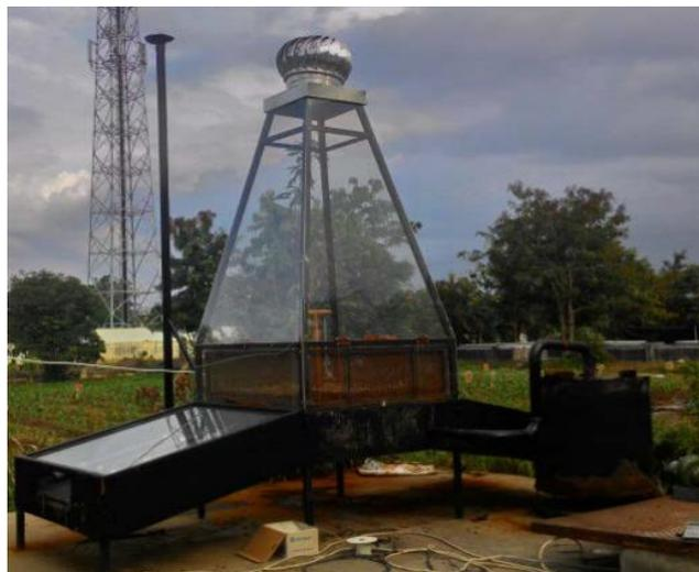
Gambar 3. Alat Pengering Tipe *Bed Dryer*.
