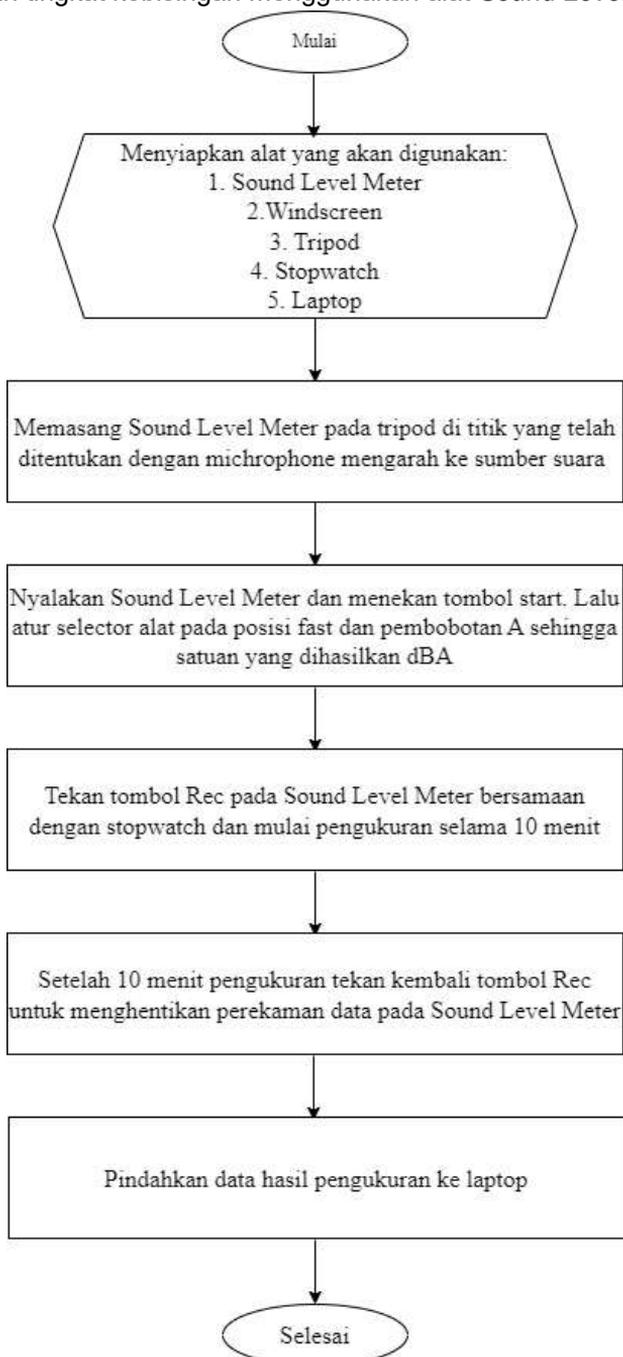
**Gambar 4. Flowchart Pengukuran Tingkat Kebisingan Menggunakan Sound Level Meter**
