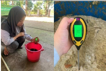
Pengukuran suhu dan pH untuk sampah organik dan limbah ampas kopi sebelum pencampuran
