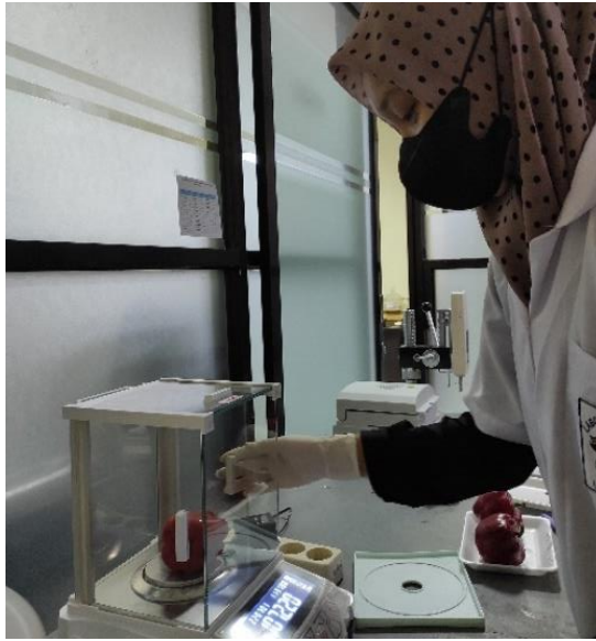
Gambar 18. Pengukuran susut bobot paprika merah
