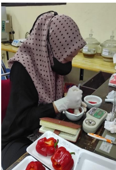
Gambar 21. Pengukuran total padatan terlarut (TPT) paprika merah.
