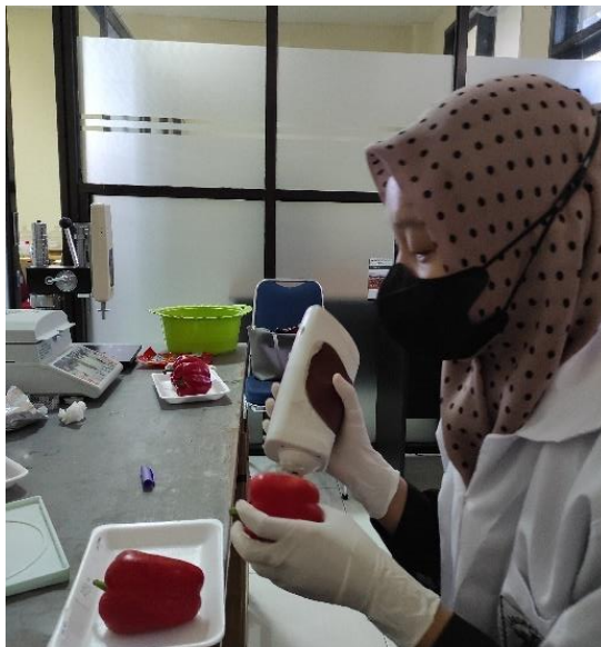
Gambar 19. Pengukuran warna paprika merah
