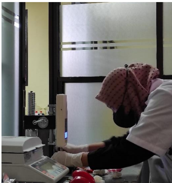
Gambar 20. Pengukuran tingkat kekerasan paprika merah
