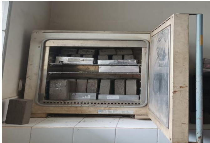
Gambar 8. Pengujian Penyerapan Air Paving Block
