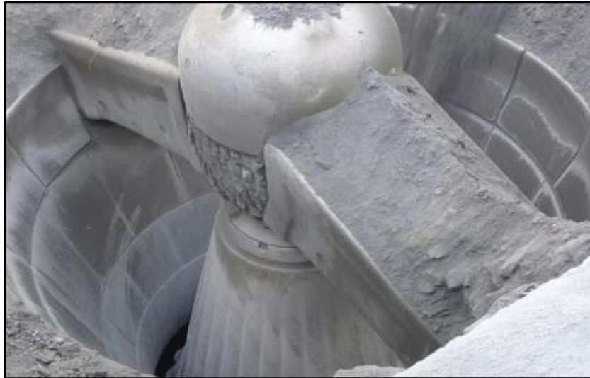
Gambar 6. Crusher gyratory di tambang terbuka Grasberg.
