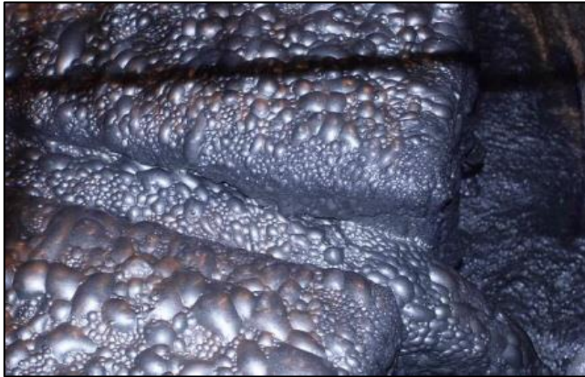
Gambar 9. Gelembung udara pada saat proses flotasi.
