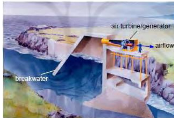
Gambar 7. Energi kinetik yang terdapat pada gelombang laut yang digunakan untuk menggerakkan turbin (sumber : Rodrigues, 2005)
