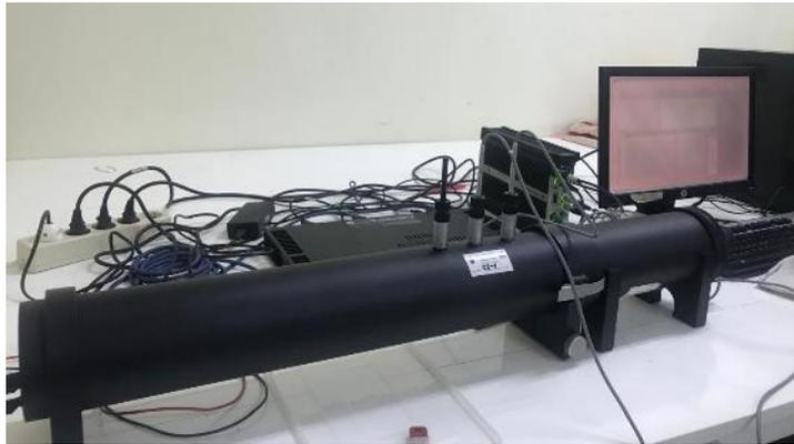
**Gambar 10. Perangkat Pengujian Tabung impedansi**
