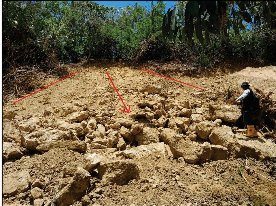
Gambar 13. *Debris Slide* (dominan batuan) pada stasiun 23 dengan arah foto N 175° E
