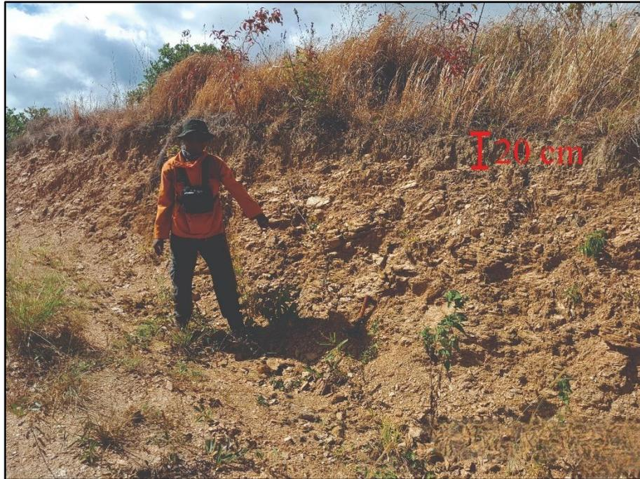
Gambar 20. Tanah berwarna coklat dengan tebal  $\pm 20$  cm hasil lapukan sekis muskovit pada stasiun 4 dengan arah foto N  $162^{\circ}$  E
