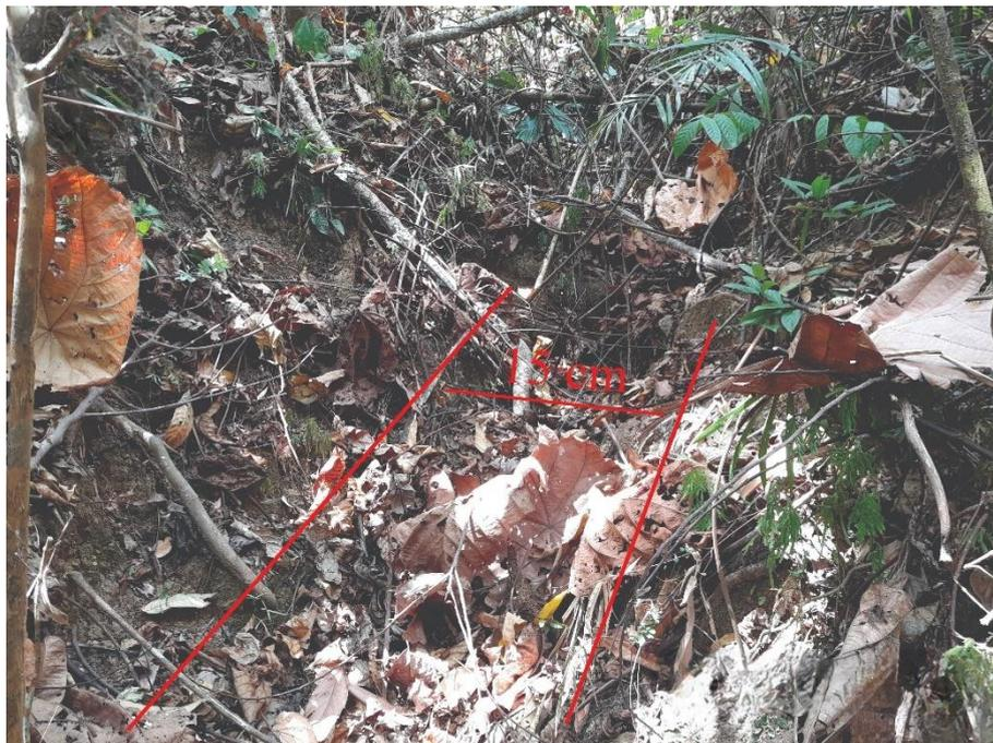
Gambar 17. Erosi alur (*rill erosion*) dengan lebar 15 cm pada stasiun 7 dengan arah foto N 16° E
