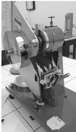
Gambar 4. 3 Alat Pengujian Sobek Elmendorf 2000
