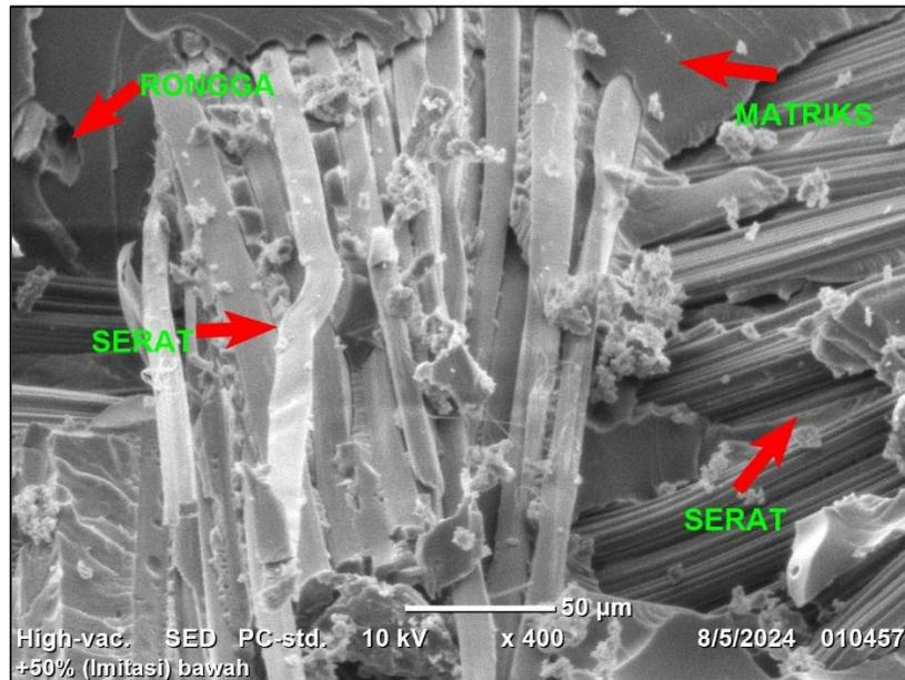
Gambar 5. 30 SEM (Scanning Electron Microscopy) maksimum pada sutra kimitasi 50%
