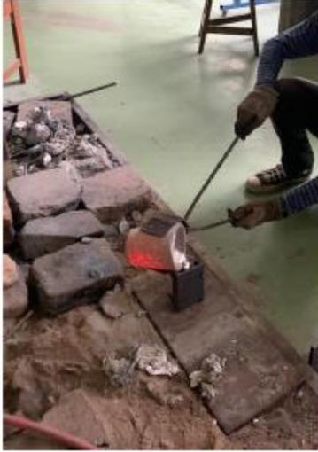
Proses penuangan ke dalam cetakan.
