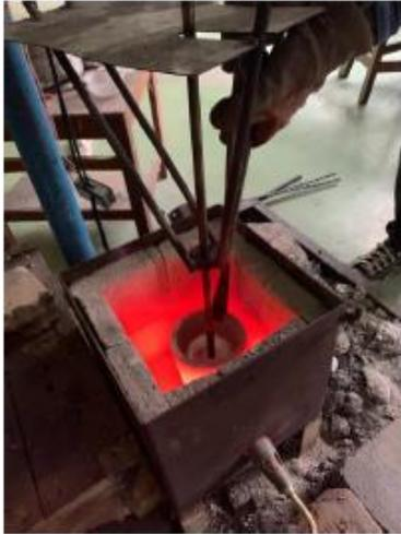
*Crucible* diputar pada saat *stir casting* agar serbuk yang telah ditabur menyebar secara merata
