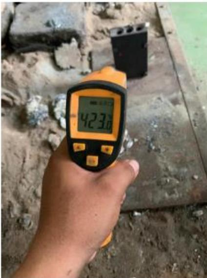
Suhu cetakan yang digunakan sebelum penuangan.
