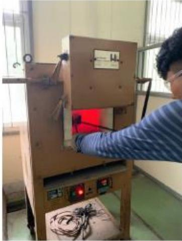
Dimasukkannya Aluminium 2024 yang telah ditimbang ke dalam *furnace* (tungku).
