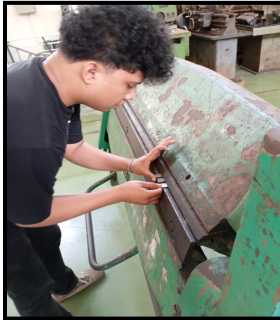
Lampiran 5. Dokumentasi proses penekukan specimen atau benda kerja.
