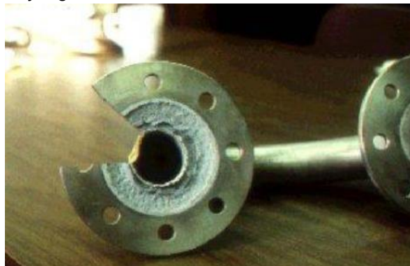
Gambar 6 Crevice corrosion (korosi celah) (Sumber: B. Utomo, 2012)
