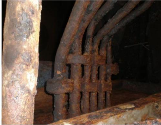
Gambar 1 Korosi Seragam (Sumber: B. Utomo, 2012)
