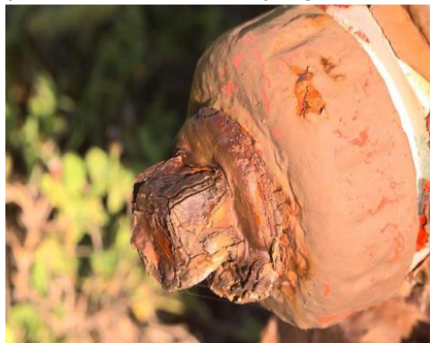
Gambar 8 Fatigue corrosion (korosi lelah) (Sumber: B. Utomo, 2012)
