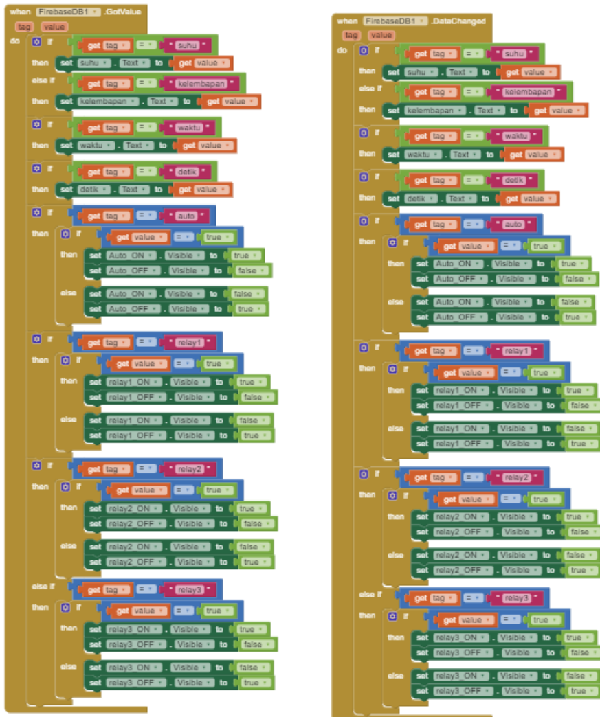
Blok Untuk Menampilkan hasil pembacaan sensor-sensor dan aktuator yang diambil dari firebase
