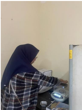
Gambar 12. Mengukur Kadar Air Berat Kering
