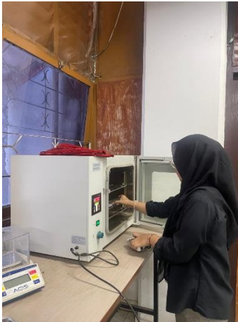
Gambar 11. Mengoven Sampel Tanah
