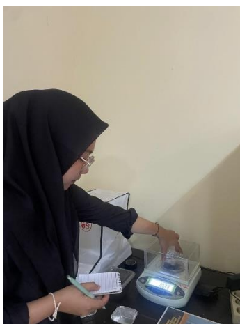
Gambar 10. Mengukur Kadar Air Berat Basah
